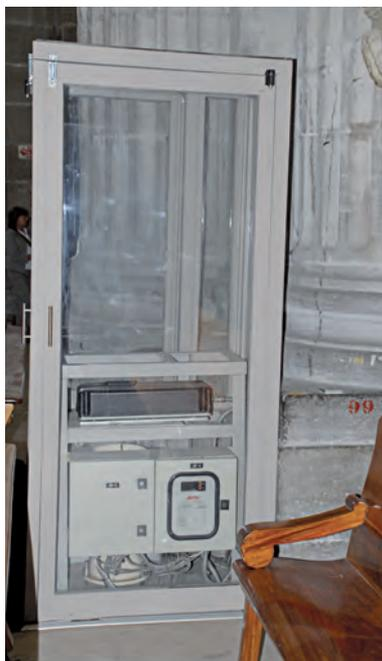
Caseta de la plomada digital (instrumento que verifica los cambios de la verticalidad de torres y columnas) localizada en el interior de la Catedral.
