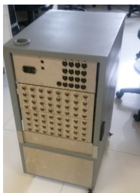
Figura 2. Chasis del equipo de captura de 80 canales con sincronización con el equipo OPTOTRAK
