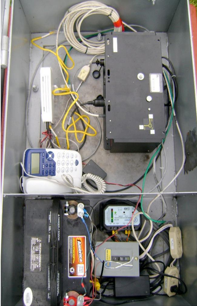
Figura 3. Acelerógrafo, modem, batería, regulador y cargador de batería
