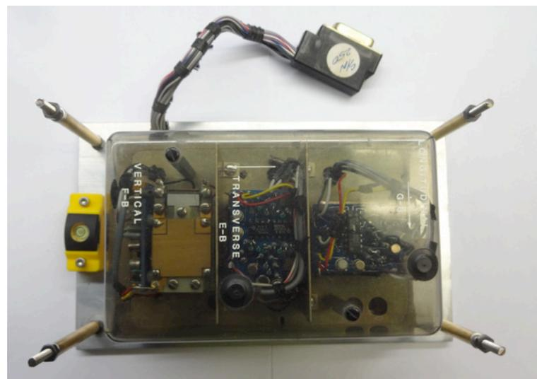
Figura 4. Acelerómetros FBA 23
