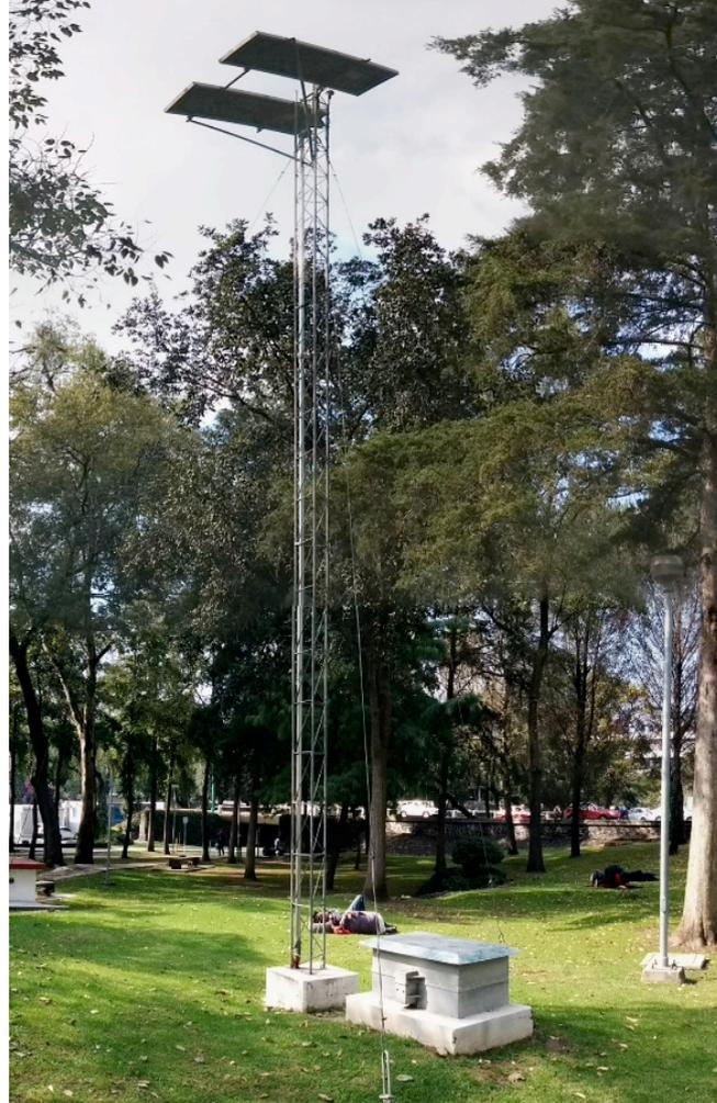
Figura 2. Estación acelerográfica autónoma típica de campo libre
