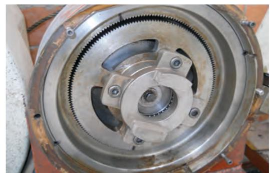
Figura 2. Transmisión cicloidal de engranes convencionales
