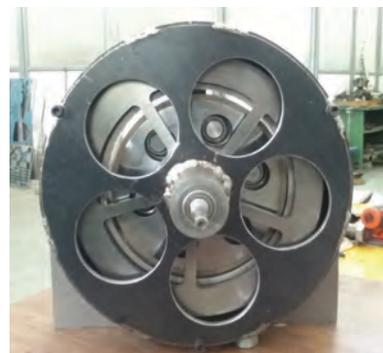
Figura 4. Reductor de velocidad de engranes magnéticos de IUNAM. Primer prototipo
