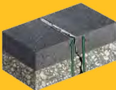
Concreto asfáltico sin refuerzo
