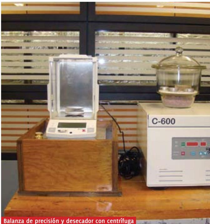
Balanza de precisión y desecador con centrífuga
