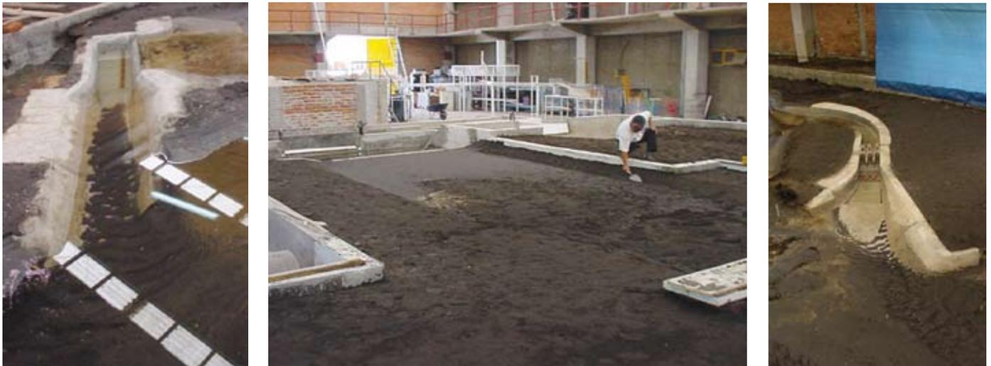
Fig 2. Modelo físico a escala 1:60 de la obra de control
