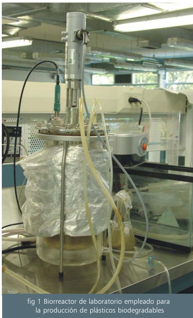
fig 1 Biorreactor de laboratorio empleado para la producción de plásticos biodegradables
