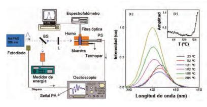
Fig 1 Arreglo experimental desarrollado para obtener el comportamiento térmico de los iones Eu<sup>2+</sup> en cristales de NaCl.
