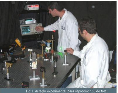
burbujas de agua en matraz esférico aplicando un campo acústico senoidal de 27 KHz.
