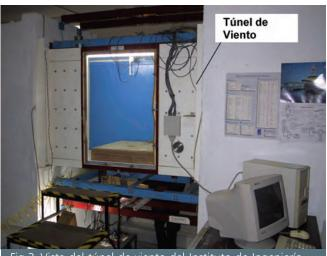
Fig 3. Vista del túnel de viento del Instituto de Ingeniería, UNAM, con su sistema de adquisición de datos
