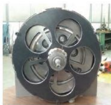
Figura 4. Reductor de velocidad de engranes magnéticos de IUNAM. Primer prototipo
