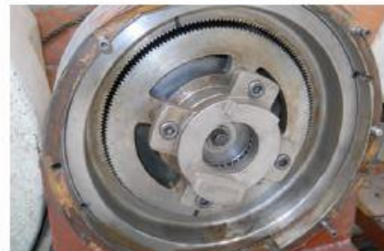
Figura 2. Transmisión cicloidal de engranes convencionales
